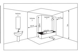
Respectez les distances minimales avec le mobilier pour l'emplacement du radiateur.
